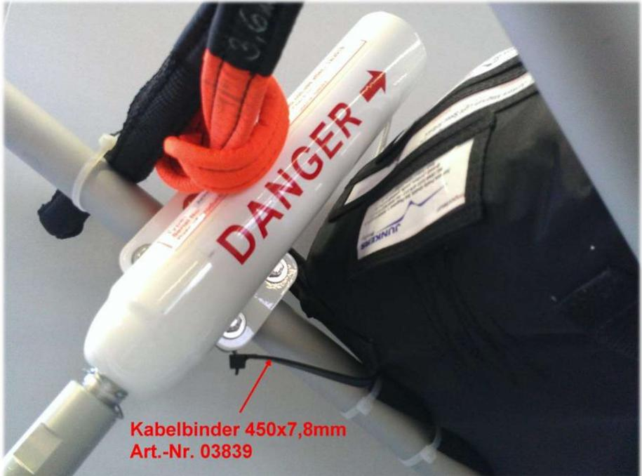
Abbildung 12: Sicherung des Rettungscontainers gegen Herabrutschen
