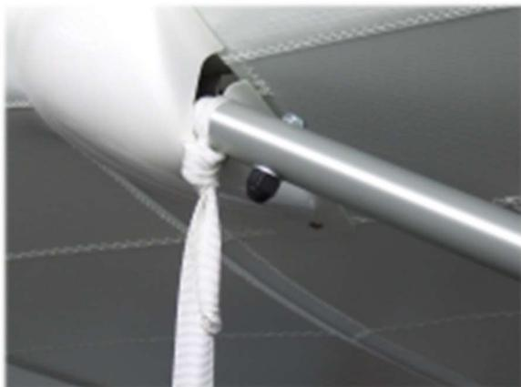
*Abbildung 5: oberer Befestigungspunkt an vorderer Flächenstrebe*
