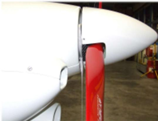
*Abbildung 6: Befestigungspunkt zwischen Cowling und Propellerspinner*
