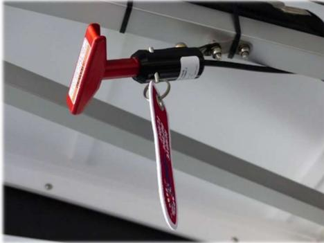
Abbildung 7: Auslösegriff mit Sicherheitspin
